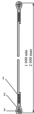
Figura 8. Ejemplo de elemento de amarre para ensayos de resistencia y prestaciones dinámicas
