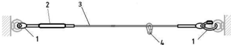
Figura 7. Ejemplo de FAL independiente como dispositivo de anclaje tipo I
